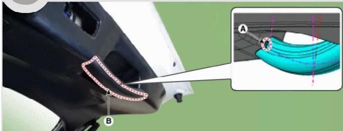
**4** Открутите **четыре болта**, снимите нижнюю **обивку двери** багажного отделения, отстегнув **клипсы**. Отсоедините разъем кнопки закрывания багажного отделения.
