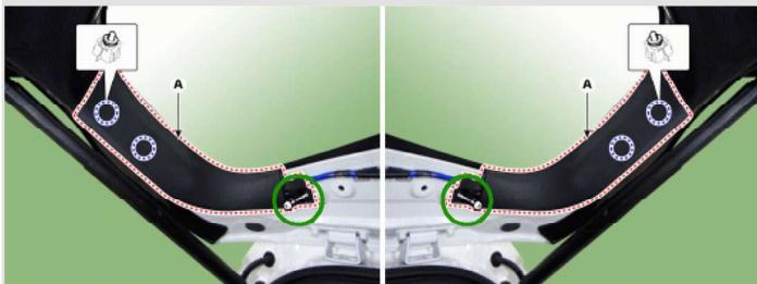
**3** Снимите **накладку** ручки закрывания багажного отделения.
