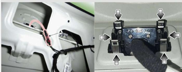
**6** Снимите **камеру заднего вида**, выверните **восемь винтов** крепления камеры.
